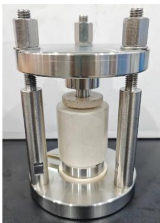
图 15 可控施加压力的固态电池测量模具
